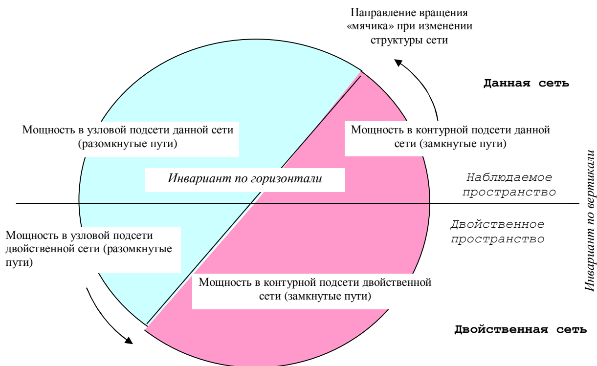
Рис. 2. Диаграмма изменения мощности в двойственных цепях при изменении структуры
