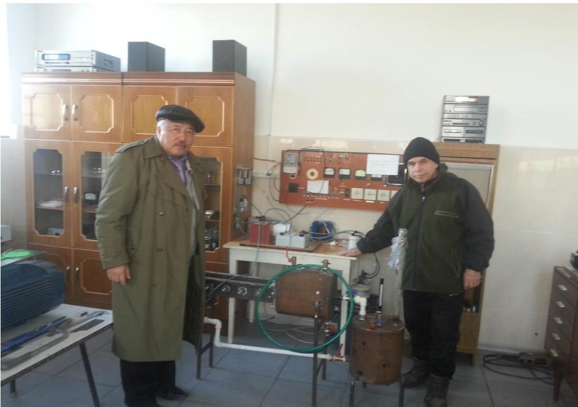
Рис. 3. Лабораторная установка – индивидуальная отопительная система на базе электрогидравлического нагревателя с кавитационной термо-камерой (ЭГН-КТК) в комплекте (слева направо: руководитель Аубакир Д.А. и конструктор Ревин Н.М.)
