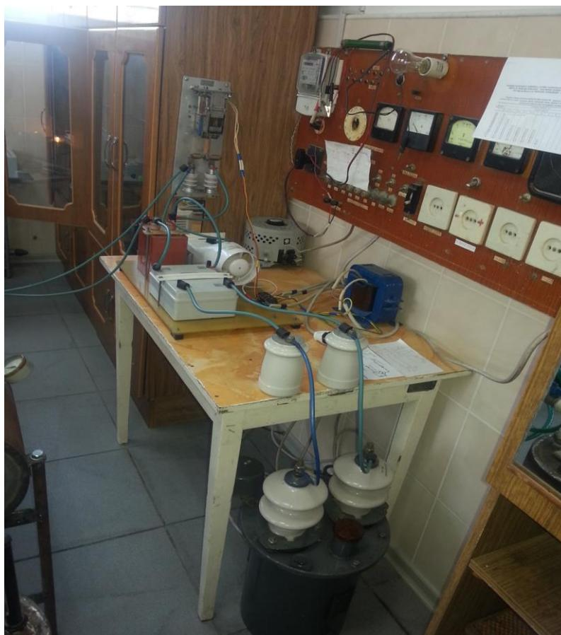
Рис. 2. Энергетическая часть ИИОС-ЭГН-КТК: блок питания, трансформатор на 1 кВт, выпрямитель, ВВ-конденсатор, газо-разрядник, соединенная с термо-камерой
