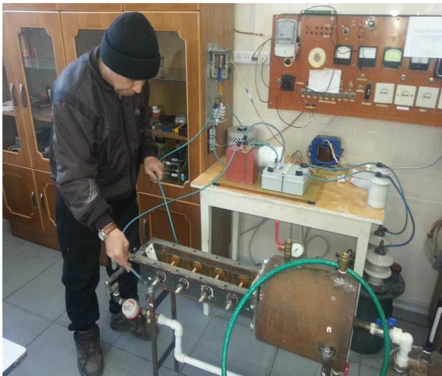
Рис. 1. Лабораторная установка ИИОС-ЭГН-КТК (индивидуально-интенсивная отопительная система на базе электрогидравлической кавитационной термо-камеры)
